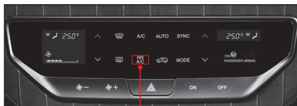
Schalter der hinteren Klimaanlage
